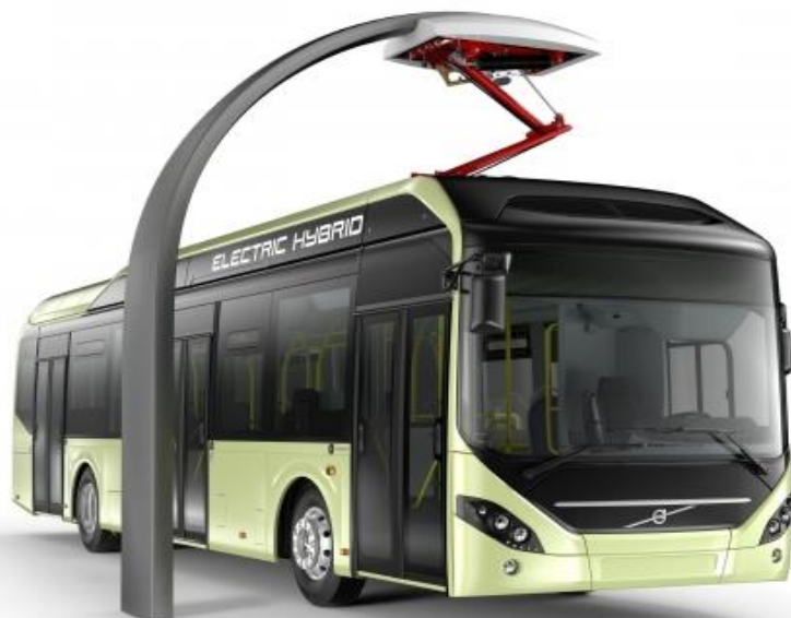
Rysunek 2. Pantografowa stacja ładowania autobusów hybrydowych
